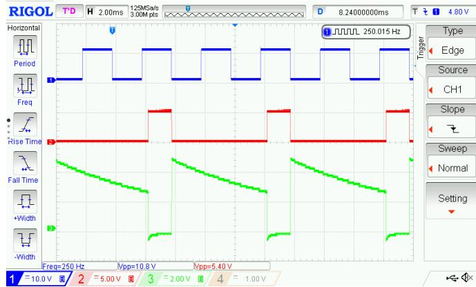
Figura 10: Formele impulsurilor în cazul repetării declanșării în perioada metastabilă (bază de timp de 2ms/div)
