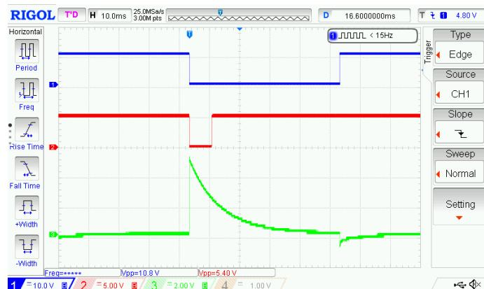
Figura 9: Impulsurile din diferite puncte ale circuitului CMB implementat cu porti NAND (bază de timp de 10ms/div)
