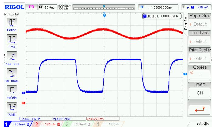
Figura 23: Forma semnalelor înainte de poartă (sinusoidal) și după poarta inversoare (dreptunghiular)
